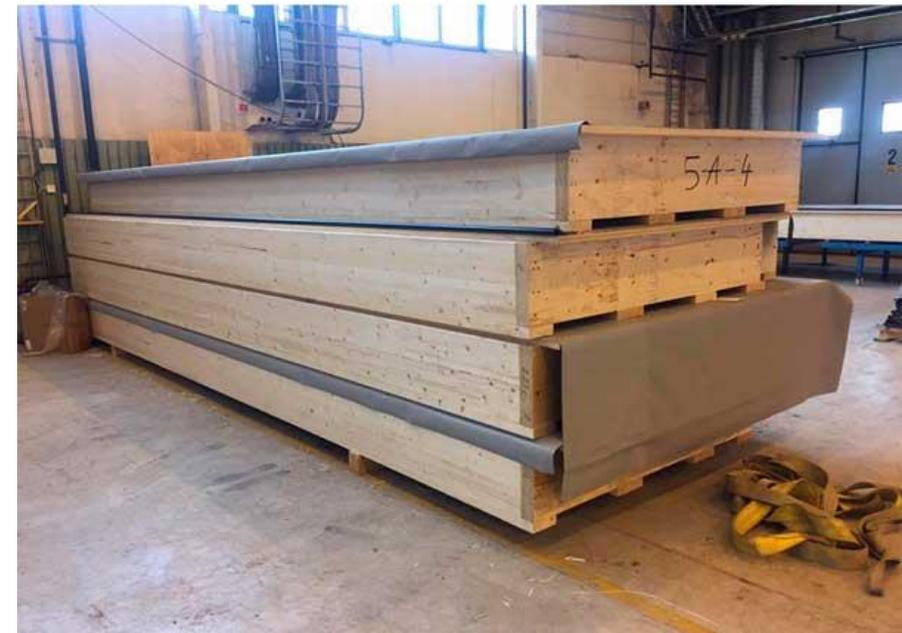
La madera utilizada en la fabricación de madera laminada cruzada es generalmente madera secada en horno C24 junto con una cantidad limitada de madera C16\*. El contenido de humedad es de aproximadamente  $12\% \pm 2\%$ , de esto la densidad de la madera oscila entre 470-590Kg / m<sup>3</sup> (dependiendo de las especies de madera). Cuando se deja visible, CLT proporciona un acabado natural y si está diseñado e instalado correctamente, requiere poco o ningún mantenimiento.
